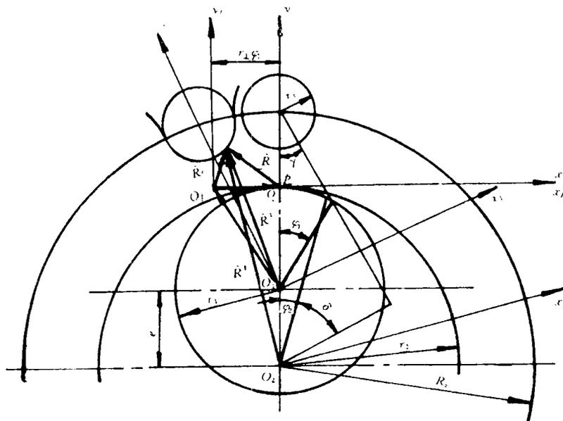
图2 摆线轮及滚刀齿形求解
