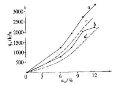
a —有机质含量 0.446% ;b —有机质含量 4.11% ; c —有机质含量 1.3% ;d —有机质含量 10.10% 图 1 有机质含量与水泥土强度关系曲线
