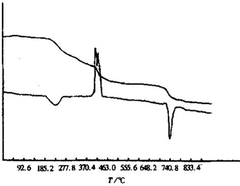
图 1 La<sub>0.56</sub>Li<sub>0.33</sub>TiO<sub>3</sub> 干凝胶 DTA 曲线
