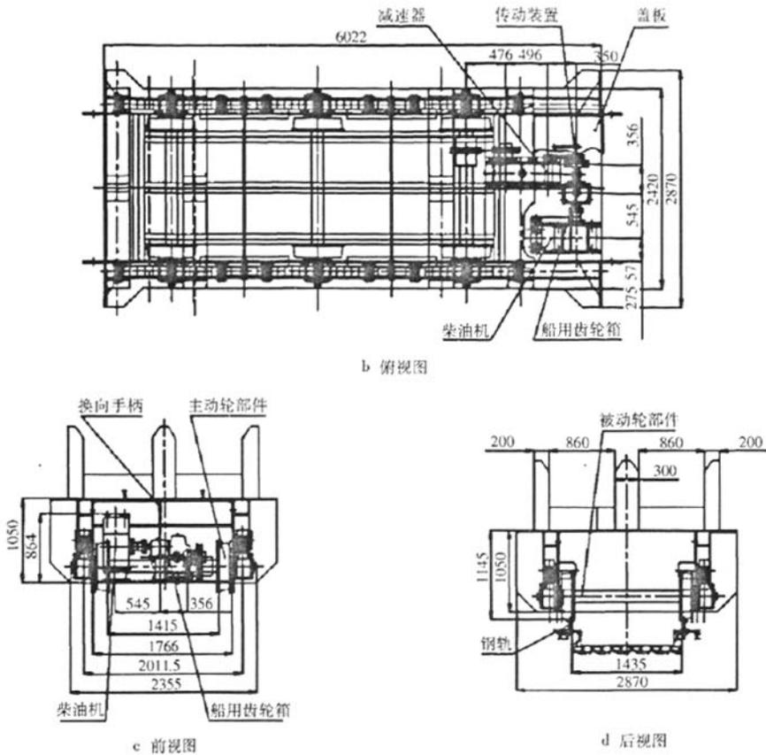
图 1 钢坯运输车总体结构示意图
