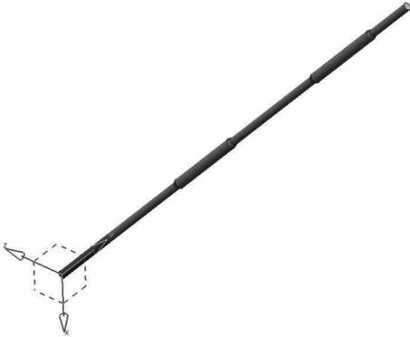
图 1 粉煤灰脉冲气流干燥器几何模型
