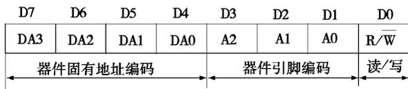
图 1 I<sup>2</sup>C 总线器件地址 SLA 格式
