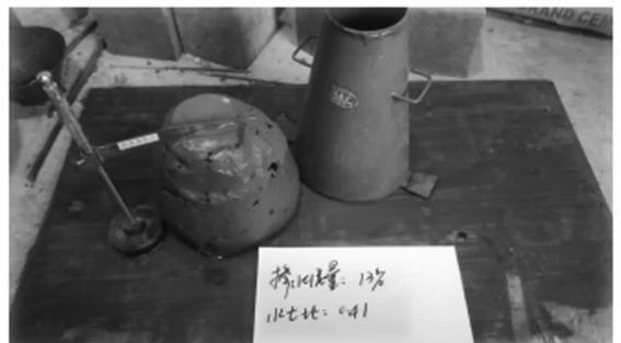
图 3 坍落度试验
