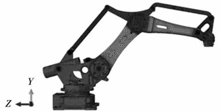
图 1 某型工业机器人整机有限元模型
