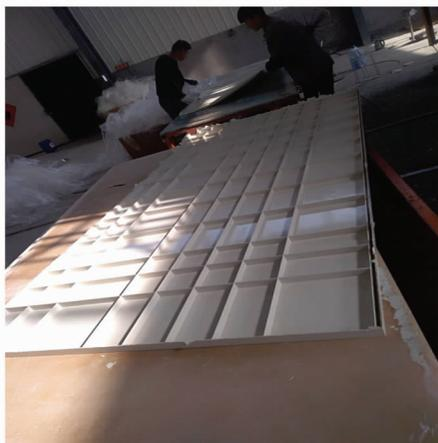
图5 SMC 复合材料整体卫浴产品的主体框架部件
